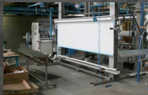
Banc de montage et d'essai pour vérification de l'aspect et du nombre de lames avec test et réglage de fin de course moteur
