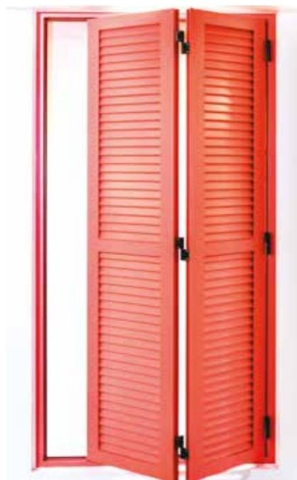
Toute en aluminium thermolaqué, cette persienne se compose de lames extrudées multitubulaires articulées qui se replient en accordéon dans l'épaisseur ou l'extérieur du tableau.
